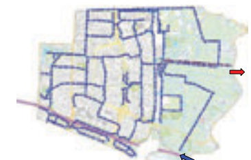
Figuur 2.4 Stromingsrichting vanaf de hoofdinlaat door het poldersysteem. De blauwe pijl geeft de hoofdinlaat aan, de rode pijl de locatie van het gemaal, van waaruit het water weer in de Amstel wordt gepompt.
